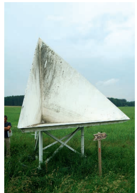
[ Radarreflektor in der Nähe von Oberpfaffenhofen ]
