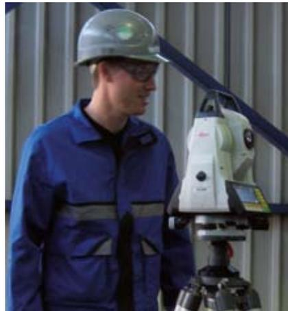
Für die Nullmessung der Kompressorposition – vor Bespannung der Anlage, darunter versteht man das unter Druck setzen des Rohrleitungssystems, wurden die an der Anlage befestigten Messpunkte mehrfach redundant beobachtet. Insgesamt wurden 25 Punkte am Messobjekt angelegt.
