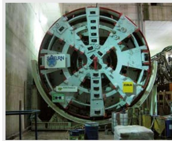
Bohrschild der Tunnelbohrmaschine
