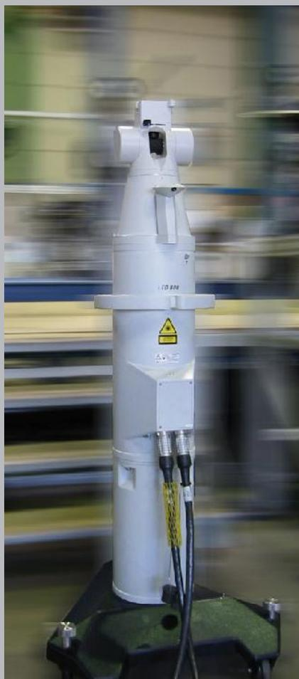
Es können hier Genauigkeiten bis zu 0,08 mm bei 10 m Objektgröße erreicht werden. Für dynamische Messungen, Deformationsmessungen und Digitalisierung finden diese Messsysteme ihren Einsatz z.B. in der Luftfahrt-, Automobil- und zahlreichen anderen Industriezweigen.
